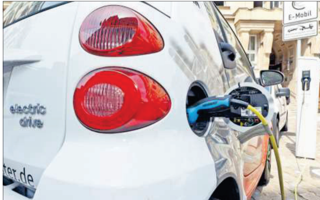
Das Niederspannungsnetz ist nicht darauf ausgelegt, dass viele E-Autos zur selben Zeit im selben Gebiet geladen werden
